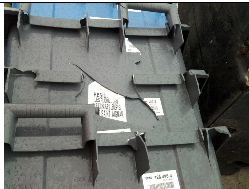
Photo n°5 : Casses poignées et cuves
